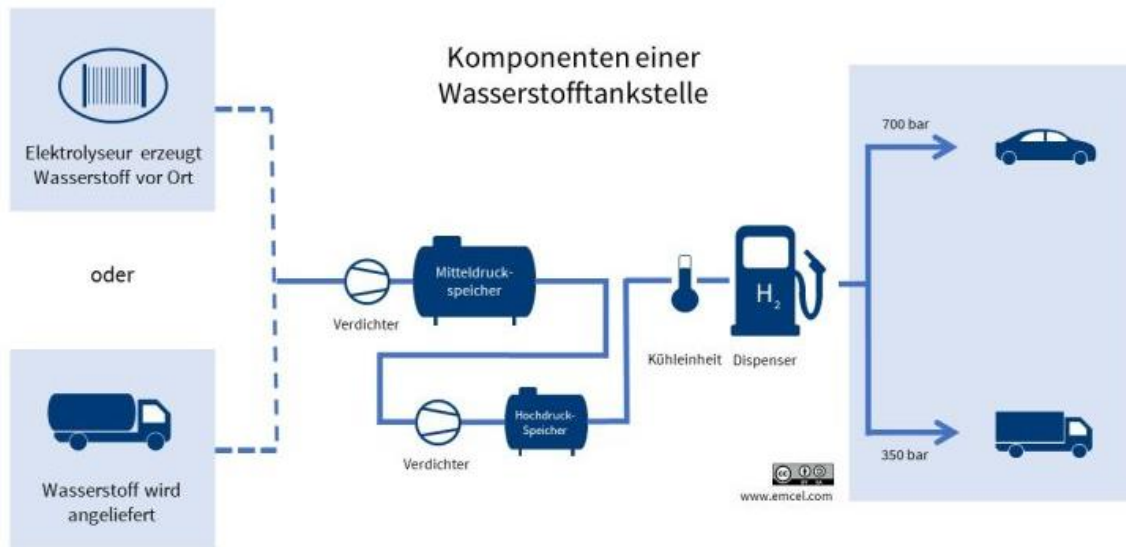
Abbildung 10 Komponenten einer Wasserstofftankstelle 13
